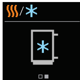
Le refroidissement est actif
