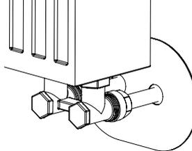
12. Remettre le radiateur en place et raccorder le robinet.
