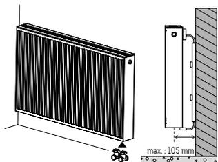
1. Installer le radiateur et mettre en place le robinet d'entr'axe 50mm.
