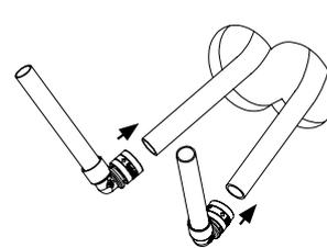
8. Sortir les tubes P.E.R. par les orifices et raccorder les cannes selon les règles de l'art.
