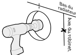
7. Percer la paroi aux emplacements ainsi repérée à l'aide d'une scie cloche (Ø67mm).
