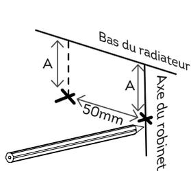
6. A partir des marques sur la paroi, repérer l'emplacement des raccordements du radiateur en reportant la distance A sur les axes du robinet.
