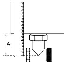
4. Mesurer la distance entre le bas du radiateur et le centre du robinet (A).
